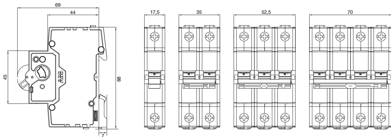
— Габаритные размеры ВДТ в мм
