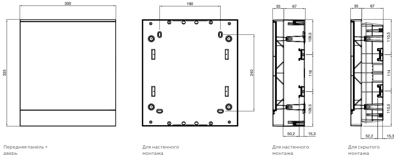
Корпус на 36 модулей, размеры в мм
