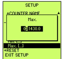
Se il valore di fondo scala minimo è inferiore al valore di fondo scala massimo l'uscita di corrente sarà direttamente proporzionale alla grandezza di riferimento, in caso contrario risulterà essere inversamente proporzionale. Minimo e massimo possono essere valori negativi.
