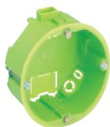
Плоская коробка для полых стен, жаропрочная, специальная коробка с минимальной глубиной (35 мм), для тонких стен толщиной 1- 20 мм, с запатентованным каналом-соединителем, расстояние между винтами 60 мм
