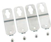
Скобы для наружного крепления для монтажа отдельных корпусов или устройств на ровные стеновые поверхности, могут устанавливаться на тыльной стороне под углом 0°, 45°, или 90°, расстояние от стены 7 мм.
