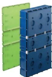
K8 - коробка для установки в бетонных стенах укомплектована монтажным шаблоном, для всех видов крепления в опалубке программы IBT, используется для монтажа во встречную опалубку и для крепления магнитом
