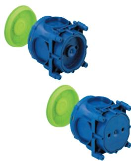
Подрозетник для труб большого диаметра, для установки в бетонных стенах, 4 винта с расстоянием между ними 60 мм, комбинируется с другими подрозетниками, используется для монтажа во встречную опалубку
