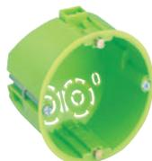
Установочная коробка для полых стен, жаропрочная, универсальная коробка для стен толщиной 1 - 40 мм, с запатентованным каналом-соединителем и дыроколом, расстояние между винтами 60 мм
