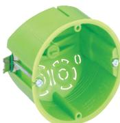
Соединительная коробка для подвески потолочных светильников в полых стенах, жаропрочная, для стен толщиной 0,5 - 33 мм, встроенная латунная втулка M 5 для потолочного крючка, максимальная нагрузка 20 N в соответствии с DIN VDE 0100
