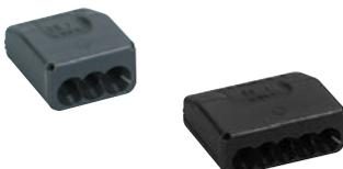
Безвинтовая соединительная клемма, для одножильного провода согласно DIN EN 60998 / VDE 0613,  $U_i = 400$  В
