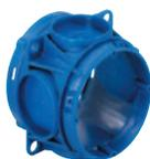
Установочная коробка для толстых бетонных стен, используется как надставка для всех коробок U 71 при использовании труб большого диаметра, расстояние между винтами 60 мм, используется для монтажа во встречную опалубку
