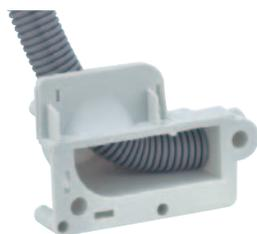
Универсальный переходник для установки в бетонных стенах, применяется для проводки трубы между стеной и потолком или для дальнейшей прокладки труб под монолитным покрытием пола. Вводы для труб до M25. Используется для крепления клеем и для монтажа во встречную опалубку
